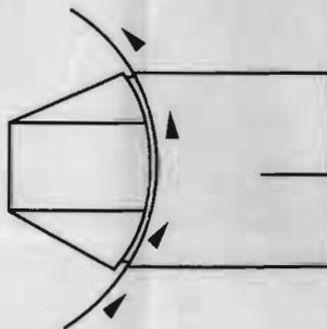
6. Coloque o sobreteto sobre a Barraca já armada e prenda seus ganchos nas argolas do fundo. Encaixe uma extremidade da haste do sobreteto no ponto de fixação do chão e empurre para formar o ultimo arco, formando o avanço da barraca. Procure distribuir o tecido do sobreteto de modo a manter sempre um afastamento do corpo da barraca para não molhar o interior e manter a ventilação.
