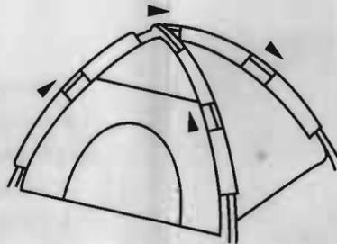
5. Desdobre o sobreteto, pegue a última haste e passe pelos passadores tipo túnel localizados internamente.
